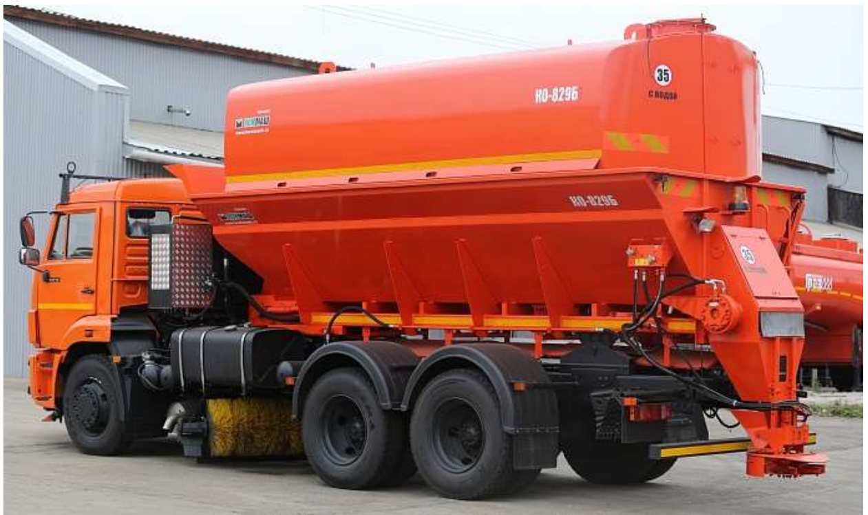
Рисунок 2.54 – Комбинированная универсальная машина КО 829Б на базе КамАЗ 65115.
